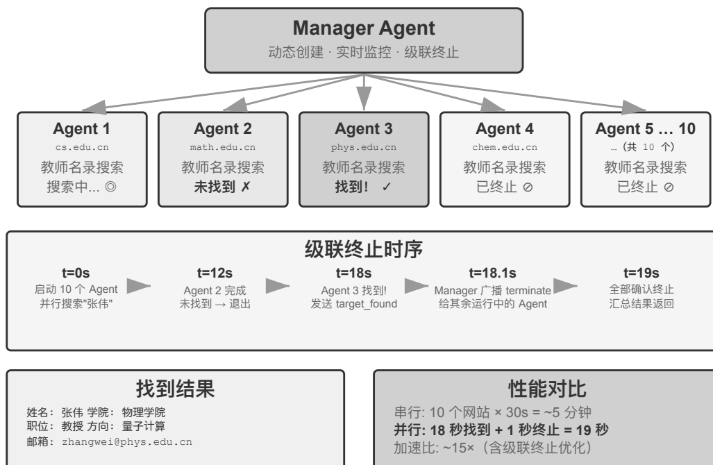
图 10-8 并行 Web Scraping 架构
