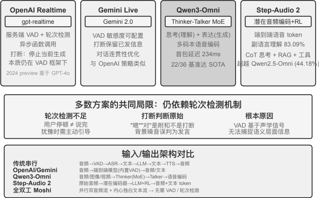
图 6-9 端到端多模态语音模型架构对比
