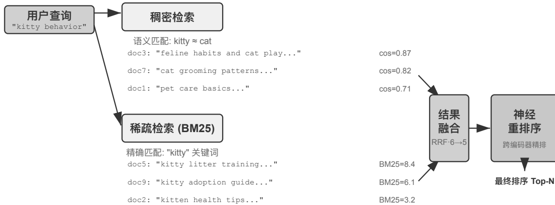
图 3-9 混合检索与重排序流水线
